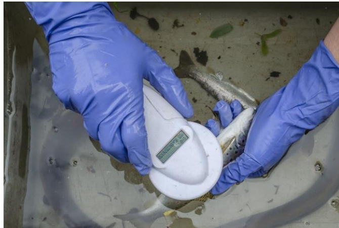
Figure 9 : Lecture d'une marque de type PIT-tag sur un individu recapturé
