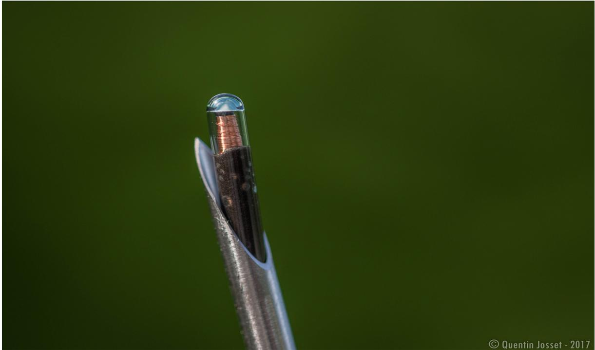
**Figure V.1.** Marque individuelle passive de type PIT-tag (12mm).
